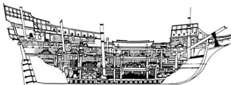
Corte longitudinal de un galeón del siglo XVII. Miguel de Aristeguieta fue uno de los más afamados constructores de naves del siglo XVII en el Cantábrico. Su nombre aparece asociado, en ésta, y otras actividades, al de su hermana, Gracia de Atocha.
